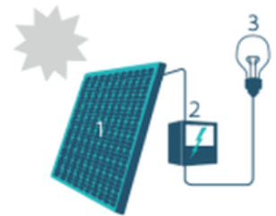
1. Zonnepaneel | 2. Omvormer | 3. Elektrische toestellen
